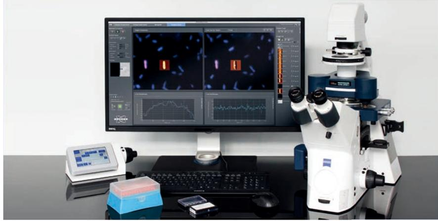
**Morphology:** 新しいソフトウェア機能 DynAsystと改良されたDynamic PIDにより、壊れやすく、固定されていない試料の表面形状を高速かつ低荷重で簡単に計測できます。
